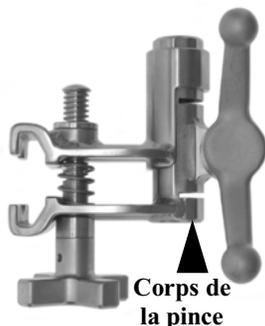
**Poignée papillon :** Pour un verrouillage adéquat, le montant doit être inséré au niveau du bas de la pince ou plus bas. Tourner la poignée papillon dans le sens des aiguilles d'une montre pour serrer fermement. Cela comprimera le corps de la pince autour du montant.
