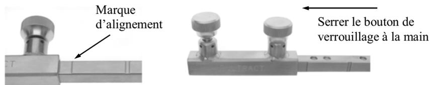
Attacher le dispositif à rochet/griffe ou une barre d'extension au montant supérieur et/ou à la barre. Glisser le tube avec la barre et les accessoires sur un montant supérieur. Le bouton de verrouillage doit être aligné avec un cran. Serrer le bouton de verrouillage fermement à la main.
