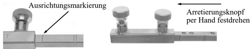
Kurbel/Spreizer oder Verlängerungsstange an Oberstütze und/oder -stange anbringen. Röhre mit Stange und Zubehör zu einer Oberstütze schieben. Arretierungsknopf muss an einer Vertiefung ausgerichtet sein. Knopf per Hand festschrauben.
