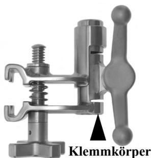
**Flügelgriff:** Zum Einrasten muss die Stütze so weit eingeschoben werden, dass sie bündig mit der Unterseite der Klemme oder niedriger liegt. Zur sicheren Befestigung den Flügelgriff im Uhrzeigersinn festdrehen. Dadurch wird die Klemme an der Stütze festgedrückt.
